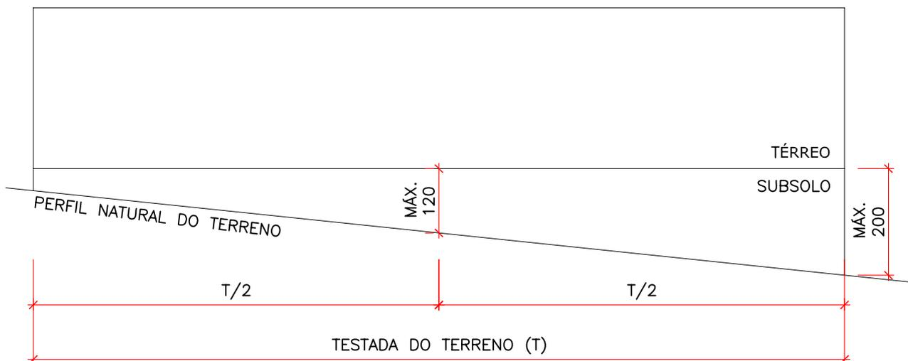
– ESQUEMA GRÁFICO ESCALONADO PARA SUBSOLO SITUADO EM TERRENO COM ALINHAMENTO FRONTAL COM INCLINAÇÃO ACENTUADA OU COM DUAS TESTADAS OU INCLINAÇÃO NA SUA PROFUNDIDADE
